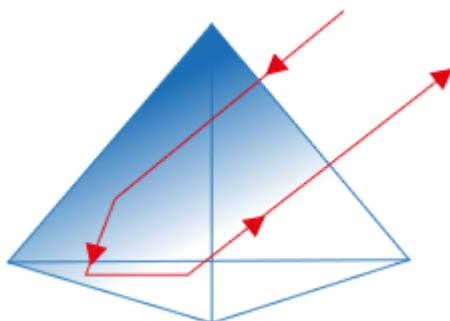
Луч света, попадая на такой материал, трижды преломляется на внутренних гранях микропризмы, после чего усиленный свет возвращается обратно к источнику света. Этим достигается оптический эффект возвращения светового потока.
